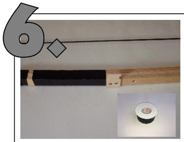
In der Mitte und an den Stellen wo der Kabelbinder ist wird Isolierband herum gewickelt.
