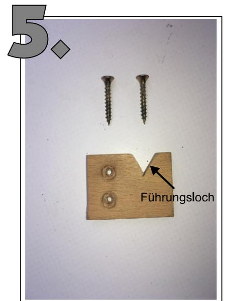
Am Plättchen links vom Führungsloch zwei Löcher mit dem 2mm-Bohrer vorbohren. Jetzt kann das Führungsplättchen in der Mitte des Bogens (Oberseite des Blättchens unterhalb der Mittellinie anlegen) mit zwei Holzschrauben am Bogen befestigen (Achtung: Auch hier vorbohren!).
