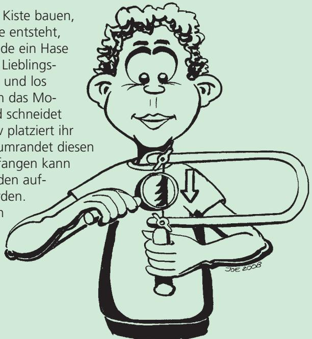
Nun spannt man das Sägeblatt auf der einen Seite der Säge ein und führt dieses anschließend durch das Loch in der Motivzeichnung. Erst danach spannt man es auf der anderen Seite der Säge wieder ein.
