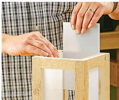
6.) Das Einsetzen der Acrylglascheiben. Fixieren kann man sie mit einem Tupfen aus der Klebepistole
