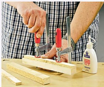
2.) Bei den Aufdoppelungen für die Eckstützen reicht eine Verleimung (mit Zwingen fixieren)
