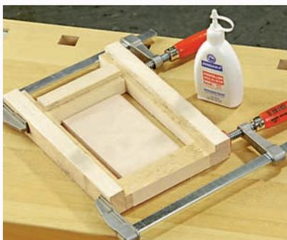
3.) Eine Distanzplatte aus Sperrholz gibt das lichte Maß für die Rechtecköffnung eines Rahmenteils vor
