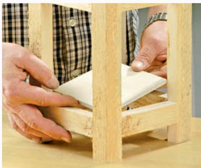
5.) Vor dem Einsetzen der Acrylglascheiben wird eine passende Quadrat-Fliese in das Gehäuse eingelegt
