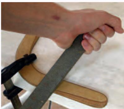
Zuerst wird mit der Raspel, dann mit der Feile das Profil herausgearbeitet. Dies ist aber nur bei stabilem Sperrholz zu empfehlen, bei dem Kiefernholz besteht hier die Gefahr, dass es splittert (siehe Abbildung 3).
