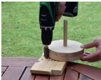
**Anfertigung eines Hilfsmittels:** In einem Holz-Reststück (18 mm dick) und mindestens 35 cm lang wird an einer Ecke ein 16 mm Loch gebohrt, durch das das Rundholz mit dem vorläufigen Kreis durchgesteckt werden kann. Ein weiteres Loch mit 12 mm Durchmesser wird im benötigten Abstand (150 mm – Radius des Stabes – Dicke des Schleifpapiers) gebohrt.
